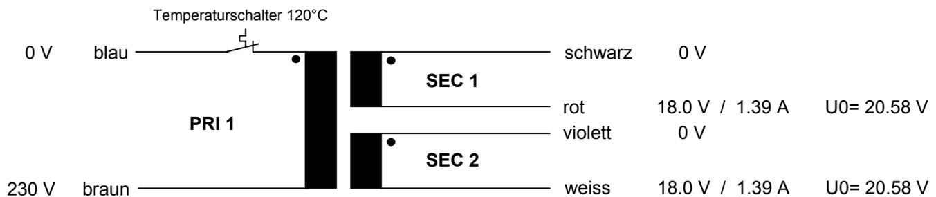
Verschaltungsmöglichkeiten: Parallelschaltung **18.0V / 2.78A** = schwarz mit violett und rot mit weiss verbinden
