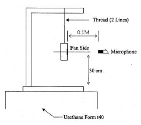
0.1 METER FROM MICROPHONE TO FAN INTAKE
