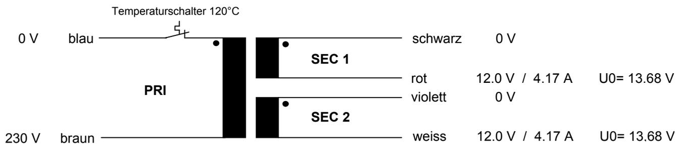
Verschaltungsmöglichkeiten: Parallelschaltung **12.0V / 8.34A** = schwarz mit violett und rot mit weiss verbinden
